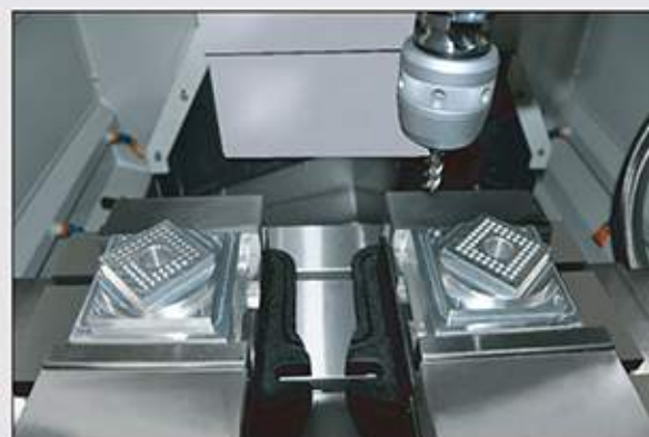
▲ T500 / T700 高速加工極高速鑽孔攻牙 (AL7075) High speed & drilling cutting
